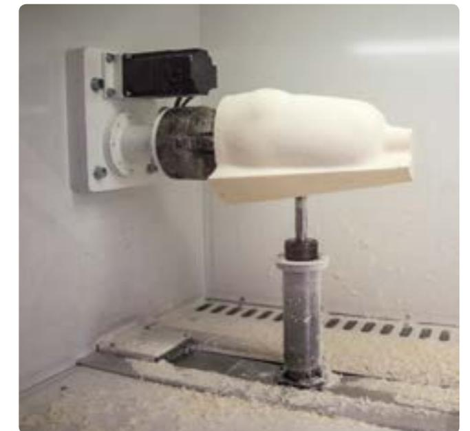
Fräsen des Modells an CNC-Fräse
